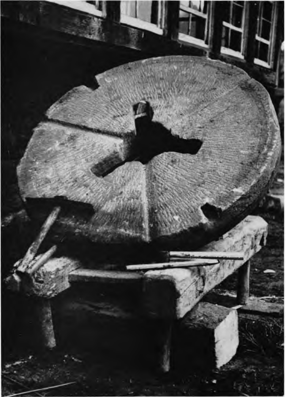
Abb. X Läuferstein auf dem Schärfestuhl mit den zum Schärfen nötigen Werkzeugen. Links auf dem Läufer die Bille.
