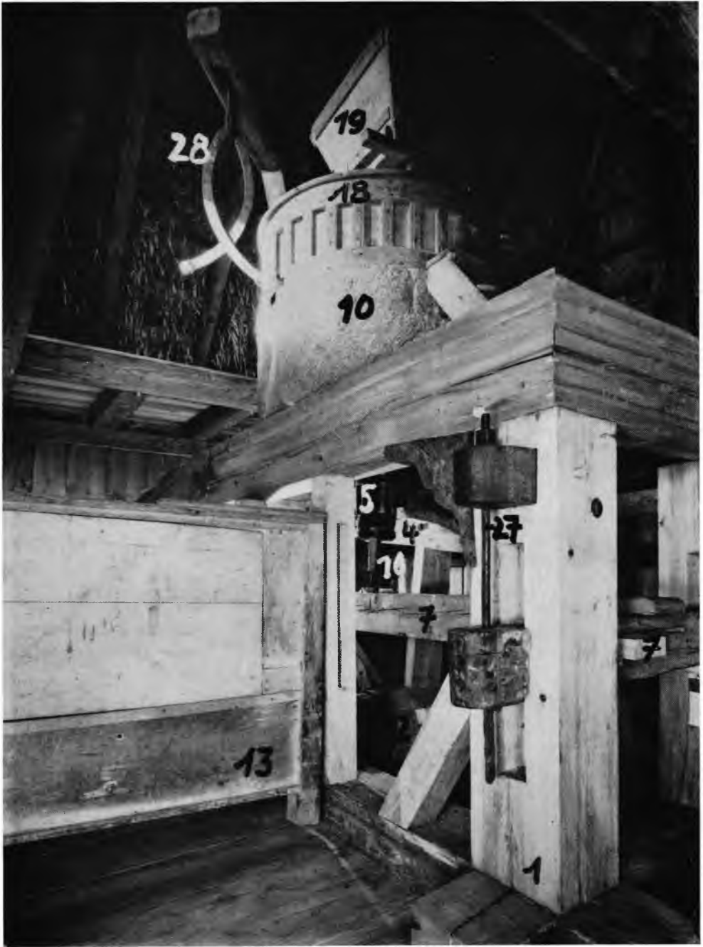
Abb. XIV Biet mit Mahlwerk. 1 Bietsäule, 2 Wellbaum, 4 Kammrad, 5 Kolben, 7 Steg, 10 Bodenstein, 13 Mehlkasten, 16 Zweis Schlag, 18 Zarge, 19 Einschnitttrichter, 28 Felgen
